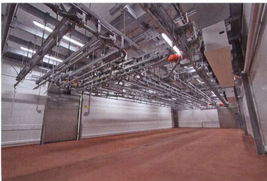
Die Schweinehälften werden automatisch im Kühlraum eingelagert oder direkt über verschiedene Förderer in den Bereich der Fleischzerlegung transportiert.
